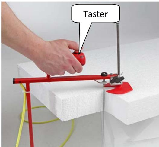
Mit dem Eckenschneider-Set können Sie Ausklinkungen und Rundungen leicht in Hartschaumplatten schneiden.
