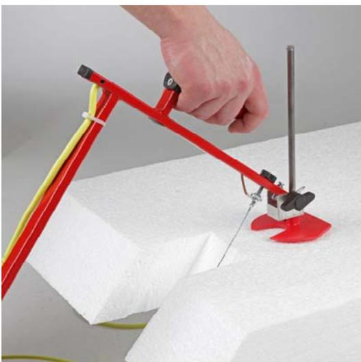
Für Sparrenausschnitte den roten Führungsteller auf den gewünschten Winkel einstellen und mit dem Führungsteller auf dem Styropor gleiten. Taster gedrückt halten.
